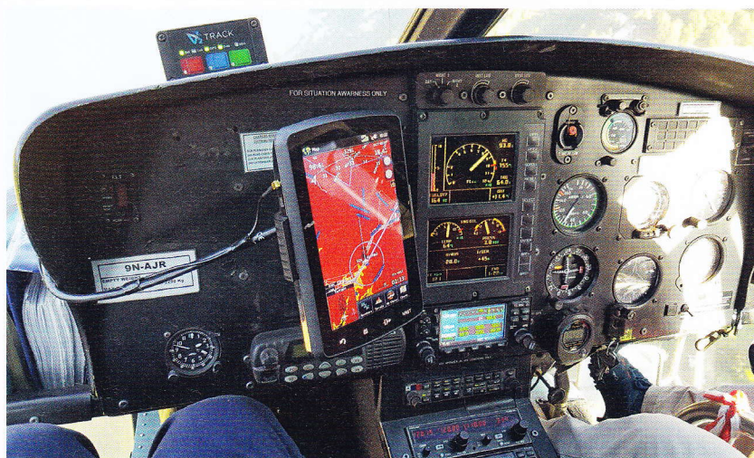
Im Heli-Cockpit hilft dem Piloten ein großes GPS-Display bei der Navigation im Luftraum. Die rote Färbung weist auf eine niedrige Höhe über Grund hin
