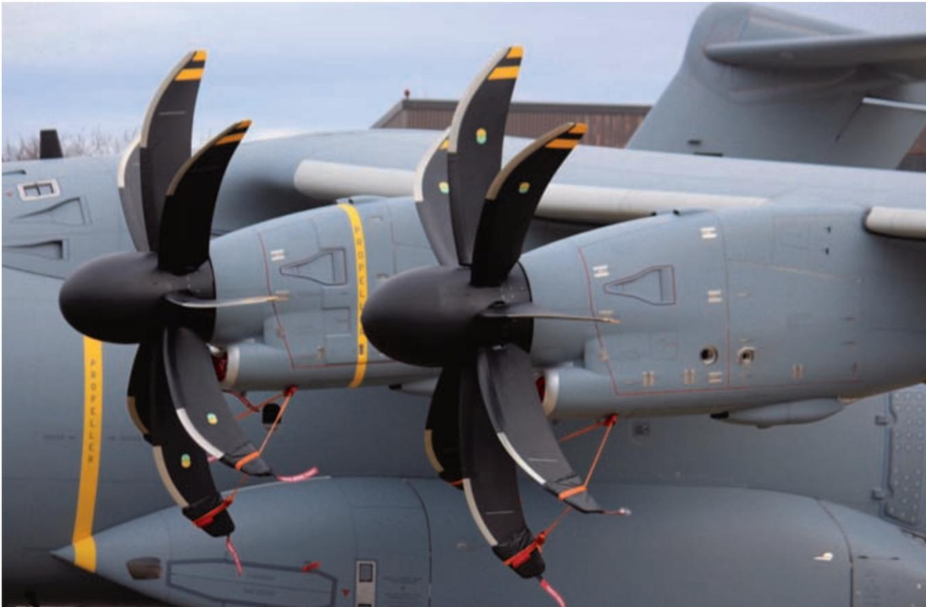
Die Triebwerke an der A400M rotieren gegenläufig, um die Drehmomente auszugleichen. Eines der vier Triebwerke der A400M hat mit seinen 11 000 PS mehr Leistung als beide Triebwerke der Transall zusammen.
