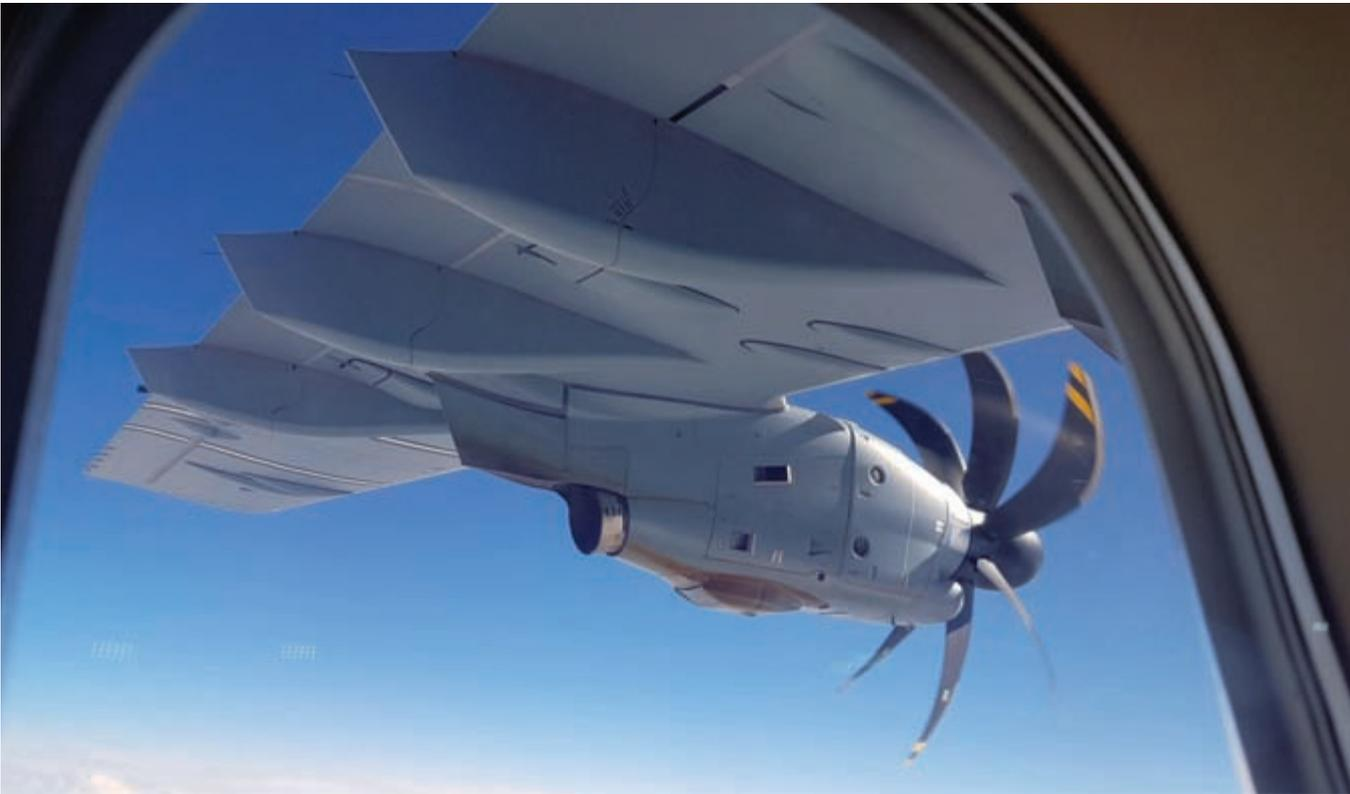
Blick aus dem Laderaum auf eines der vier EPI TP400 (Europrop International, TurboProp) Triebwerke. An den Markierungen unterhalb der Tragfläche können sich Jetpiloten beim Betanken orientieren.
