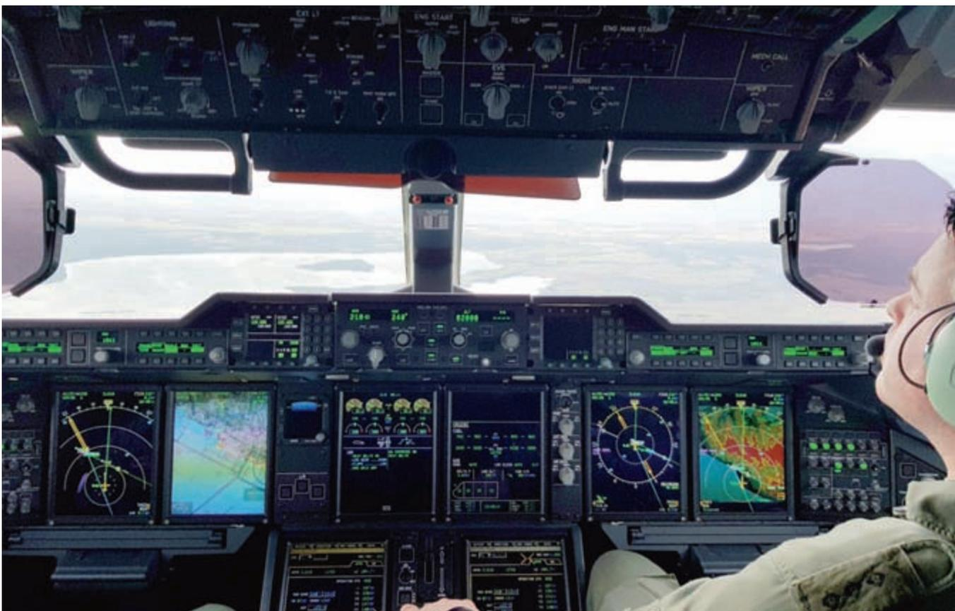
Die A400M hat eines der modernsten Cockpits mit insgesamt acht Display Units und zwei HUD (Head up Displays). Die Anzeigen auf den Bildschirmen können je nach Bedarf von den Piloten angepasst werden. Es ist dem der A380 ähnlich.
