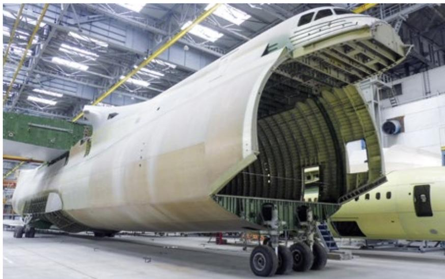
Hoffnung auf den Aufbau einer neuen AN-225 weckt ein bislang für statische Tests genutzter Rumpf im Antonow-Werk Swjatoschyn
