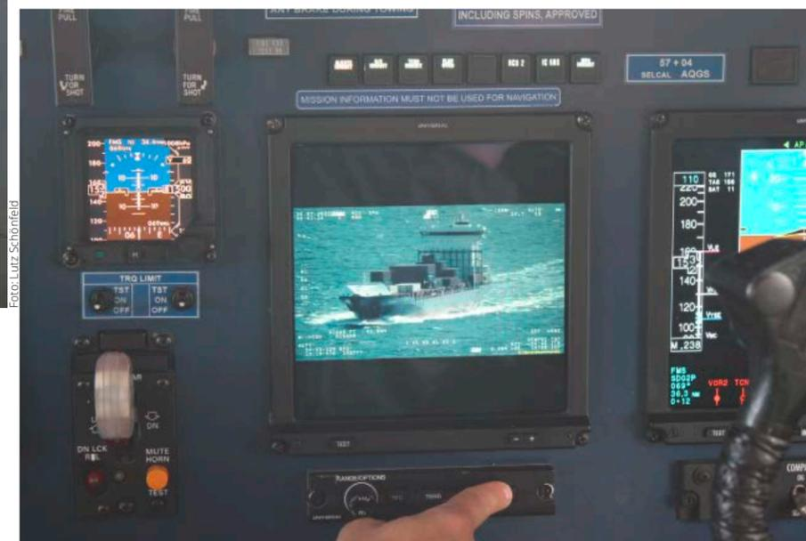
Die hochauflösende Bildgebung der neuen Missionsanlage der Do 228LM bietet auch der Cockpitbesatzung ein perfektes Lagebild
