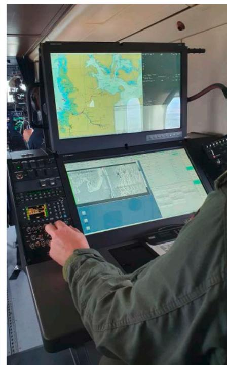
Stabsbootsmann Henrich in seinem Reich (l.). Die während des Fluges erfassten Sensordaten werden automatisch auf die elektronische Seekarte an der Konsole übertragen
