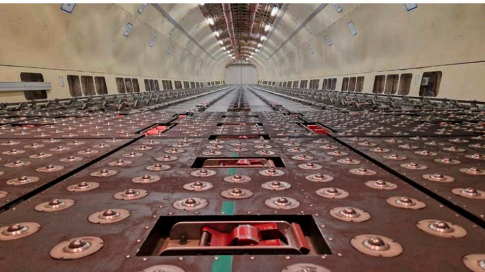
Die A300 der EAT können bis zu 45,4 Tonnen Fracht transportieren. Ein Rollensystem erleichtert die Palettenbeladung im Hauptfrachtbereich
