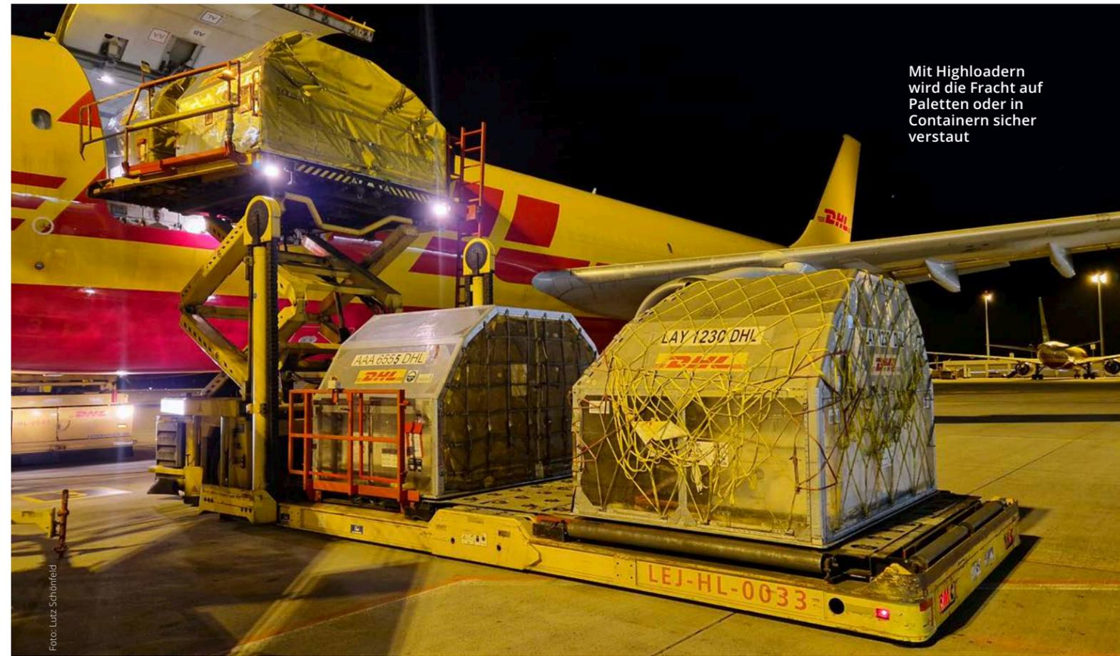
Mit Highloadern wird die Fracht auf Paletten oder in Containern sicher verstaut
